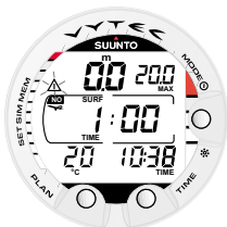
Abb. 3.30. Oberflächenintervall. Dauer der Oberflächenpause. Durch Drücken des TIME-Kontaktes wird die Dauer der Oberflächenpause dargestellt.
