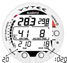
Abb. 3.9. Anzeige während des Tauchgangs. Der aktuelle Tankdruck beträgt 210 bar [3045 psi], die Restluftzeit beträgt 41 Minuten. Für 5 Sekunden nach Betätigen des Knopfes TIME wird die alternative Anzeige der aktuellen Uhrzeit und der Temperatur angezeigt.
