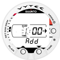
Abb. 4.20. Gewählter Modus Tauchgangsplanungs-Simulation. Fügen Sie eine Oberflächenpause ein, indem Sie die Kontakte TIME und PLAN drücken. Diese Anzeige wird nur für Wiederholungstauchgänge angezeigt.
