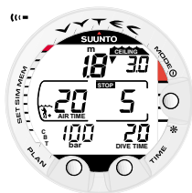
Abb. 3.15. Nicht eingehaltener verbindlicher Sicherheitsstop. Ein abwärts gerichteter Pfeil und ein akustischer Alarm signalisieren, dass Sie auf die für den Sicherheitsstop vorgegebene Tiefe abtauchen sollten.
