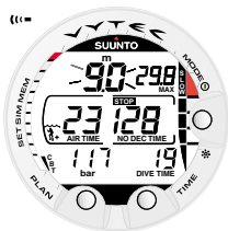
Abb. 3.13. Aufstiegsge schwindigkeitsanzeige. Blinkende Tiefenanzei ge. SLOW und 4 Segmente werden angezeigt: Aufstiegsge schwindigkeit liegt über 10m/Min [33ft/min]. Dies ist ein Hinweis, die Geschwindigkeit zu reduzieren. Das STOP-Symbol erscheint, weil Sie einen vorgegebenen Sicherheitsstopp in einer Tiefe von 6m [20 Fuss] durchführen sollten.
