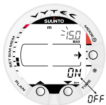
Abb. 4.27. Einstellen des Tiefenalarms. Drücken Sie PLAN/TIME, um den Alarm ein-/auszuschalten und die maximale Tiefe einzustellen.
