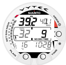
Abb. 3.25. Alternative Anzeige. Nach Drücken des TIME-Kontaktes wird die aktuelle Uhrzeit, die maximal erreichte Tiefe, die Temperatur, verbrauchte Nullzeit (CBT) und der Sauerstoffanteil O_2\% angezeigt (falls die Restluftzeit weniger als 30 Minuten beträgt).
