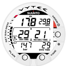
Abb. 3.23. Tauchen im Nitrox-Modus. Nachdem die Restluftzeit weniger als 30 Minuten beträgt, wird die Anzeige O 2 % durch die Anzeige der Restluftzeit ersetzt.
