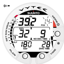
Abb. 3.24. Sauerstoffteil- druck- und OLF- Anzeige. Ein akustischer Alarm ertönt, weil der Sauerstoff- teildruck grösser als 1,4 bar bzw. der eingestellte Wert ist und/ oder weil der Sauerstoffgrenzbereich OLF 80% erreicht hat.
