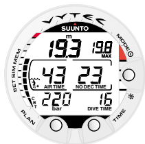
Abb. 3.8. Anzeige während des Tauchgangs. Die aktuelle Tiefe ist 19.3m [63 Fuss] und die Nullzeit beträgt im A0/ P1 Modus 23 Minuten. Die maximal bei diesem Tauchgang erreichte Tiefe war 19.8m, bisherige Tauchzeit ist 16 Minuten.
