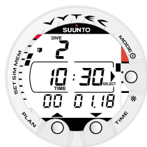
Abb. 4.11. Logbuch, Seite I. Drücken Sie den SMART/Mode (Select)-Kontakt, um zwischen den verschiedenen Tauchgängen zu blättern.
