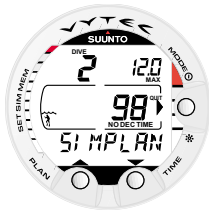
Abb. 4.20. Gewählter Modus Tauchgangsplanungs-Simulation. Fügen Sie eine Oberflächenpause ein, indem Sie die Kontakte TIME und PLAN drücken. Diese Anzeige wird nur für Wiederholungstauchgänge angezeigt.
