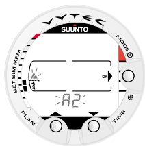
Abb. 4.23. Einstellen des Höhenmodus. Drücken Sie PLAN und TIME, um den Höhenmodus zu verändern.
