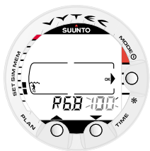
Abb. 4.25. Einstellen des RGBM-Rechenmodells. Drücken Sie PLAN und TIME, um das Rechenmodell zu ändern.
