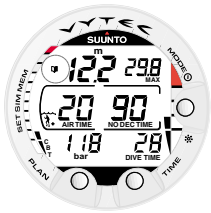
Abb. 3.10. Hinterlegen eines Lesezeichens. Ein Lesezeichen wird im Profilspeicher während des Tauchgangs eingetragen, indem der PLAN-Kontakt gedrückt wird. Beachten Sie das Logbuchsymbol, links neben der Tiefe.
