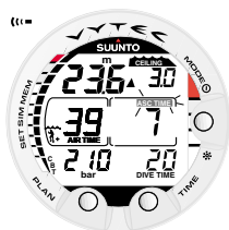
Abb. 3.16. Dekompressionstauchgang unterhalb der Dekompressionsgrenze. Der aufwärts gerichtete Pfeil und die blinkende Anzeige ASC TIME weisen darauf hin, aufzusteigen. Die minimale Aufstiegszeit beinhaltet den Sicherheitsstop und beträgt 7 Minuten. Die Deko-Stufe liegt bei 3m [10 Fuss].
