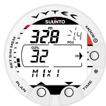
Abb. 4.28. Einstellen des ersten Gasgemisches (MIX 1). Der Sauerstoffgehalt liegt bei 32%, der Sauerstoffpartialdruck beträgt 1.4 bar. Die berechnete maximale Tiefe beträgt 32.8 m [107 Fuss]. Drücken Sie TIME oder PLAN, um den Sauerstoffprozentsatz und die Partialdruckgrenze zu ändern. Bestätigen Sie die Einstellungen durch Drücken des MODE Kontakts (OK).
