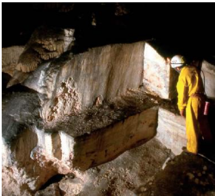
Figura 13: Dos aspectes de la pedrera subterrània que va explotar els bancs de colades estalagmítiques de la Cova de s'Ònix (Foto: A. Merino).
