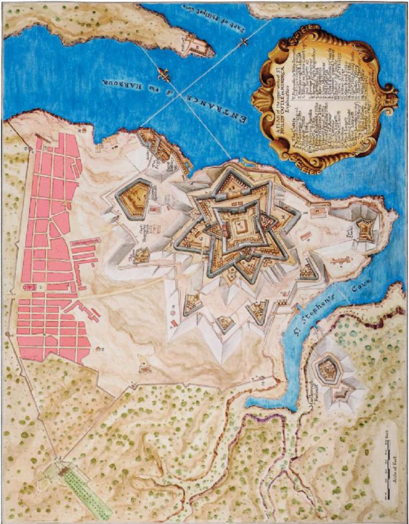
Figura 2: Planta de les obres en superfície del castell de Sant Felip a Menorca, dibuixada per Humprey Herbert el 1735. Redibuixada per l'autor afegint-li el fort d'Anstruther que aquell any encara no s'havia edificat.
